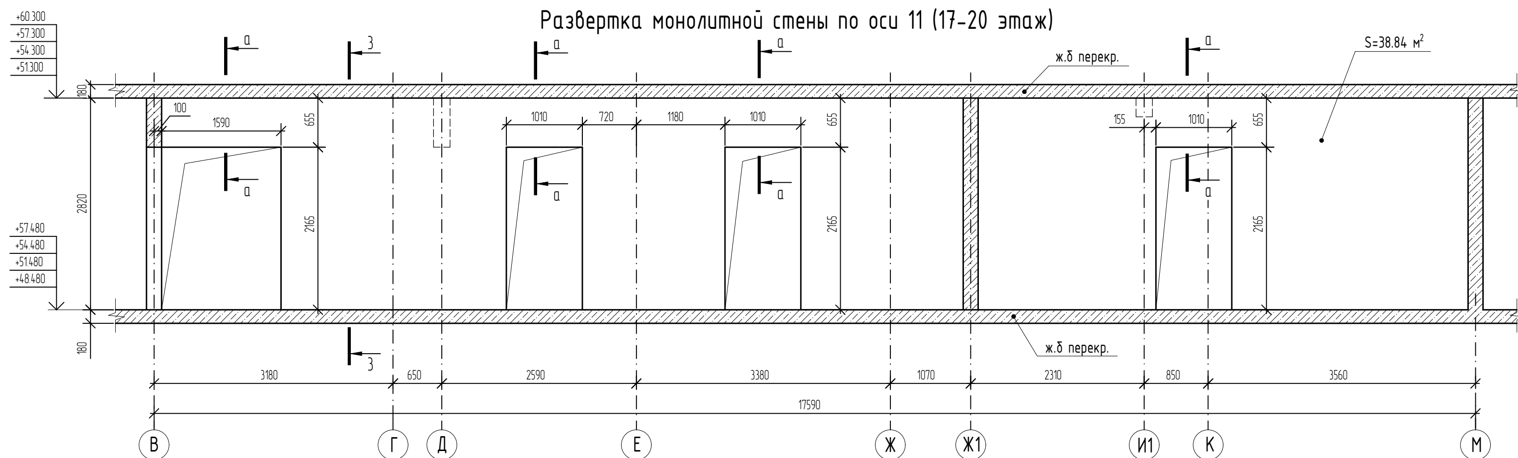
Армирование монолитной стены по оси 11 (17-20 этаж)
